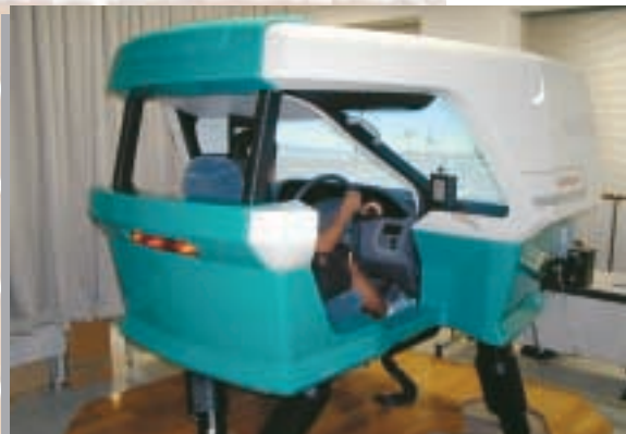
図1：運転模擬実験装置(ドライビングシミュレータ)
