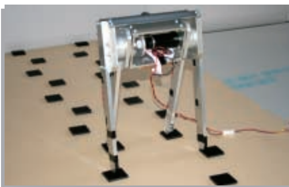
図4：飛石の上を歩くコンパス型歩行ロボット
