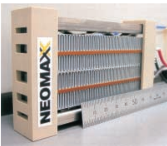
図2：鉛フリー材料を用いたPTCヒーター（左）とそのヒーター特性（右）。従来の鉛含有のものと同等の特性を示す。（株）NEOMAXとの共同研究成果
