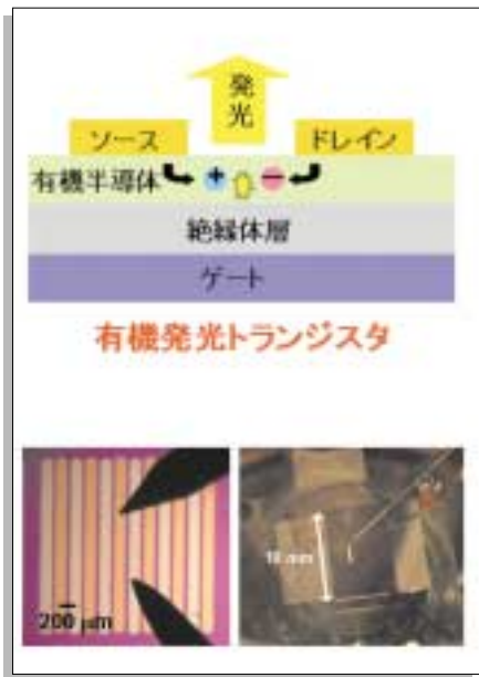
図1：有機発光トランジスタの構造（上）とその顕微鏡写真（下）。50 μmの隙間を空けた1対の金とアルミ電極の間に電圧をかけると、注入された電子と正孔が再結合して光る。ゲートにかける電圧により発光強度が変化する。
