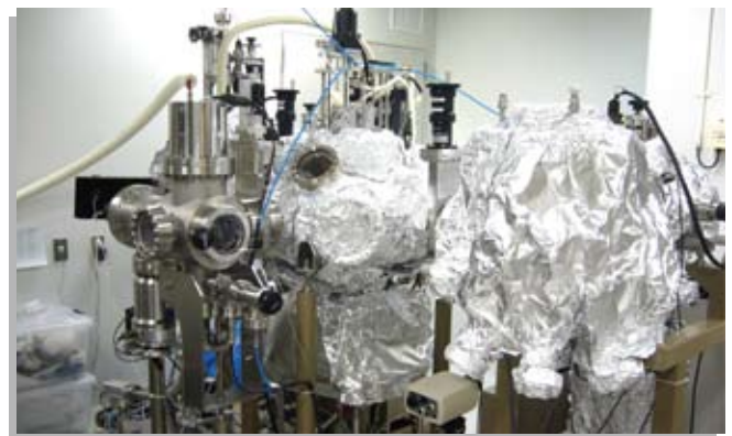
半導体薄膜結晶を成長する分子線エピタキシー装置
