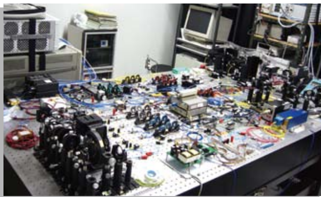
偏光双安定面発光半導体レーザーを用いた全光型バッファメモリの実験システム
