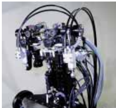
眼球運動制御系を模倣するヒューマノイドロボットの頭部
